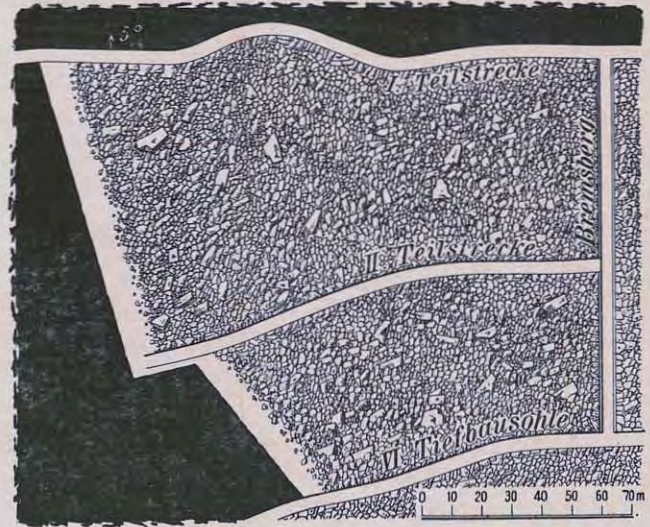
Abb. 36. Strebbau mit Schüttelrutschenbetrieb.
