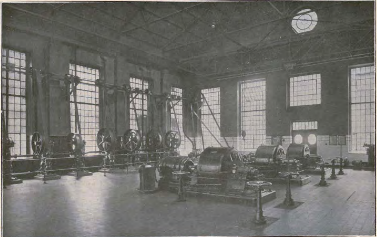
Abb. 84. Maschinenhaus der Kokerei (Gassauger und Teerspülpumpen).
