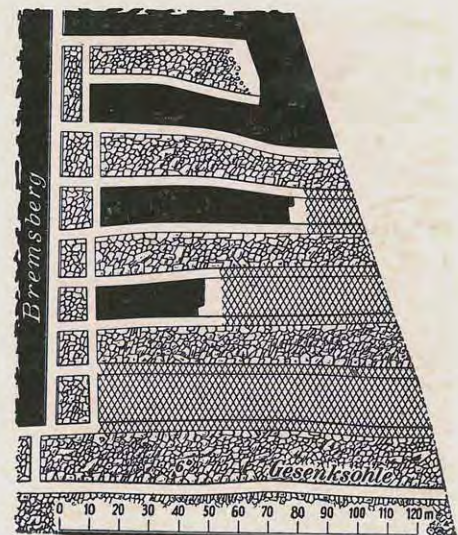
Abb. 35. Vereinigter Streb- und Pfeilerrückbau.
